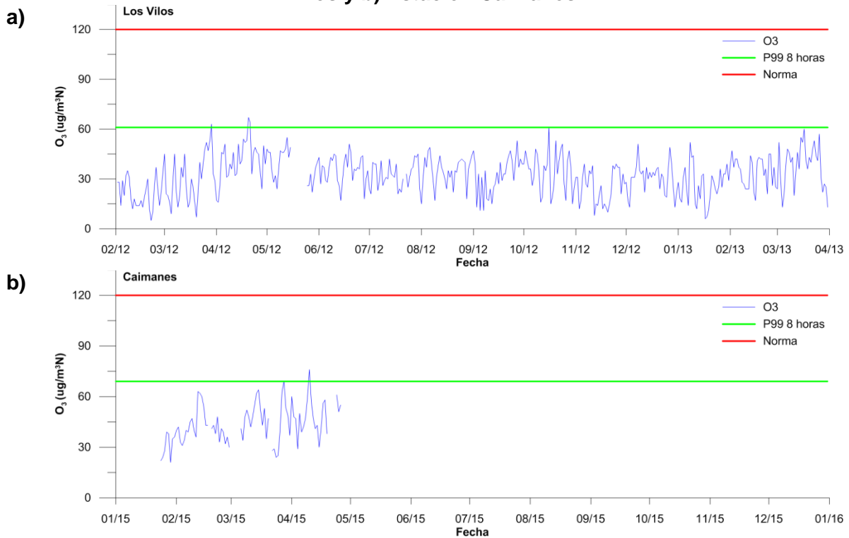
Figura CA-53: Cumplimiento Norma Primaria de Ozono, Máximos diarios de concentraciones de 8 horas, respecto de Norma Primaria para Ozono: a) Estación Los Vilos y b) Estación Caimanes
