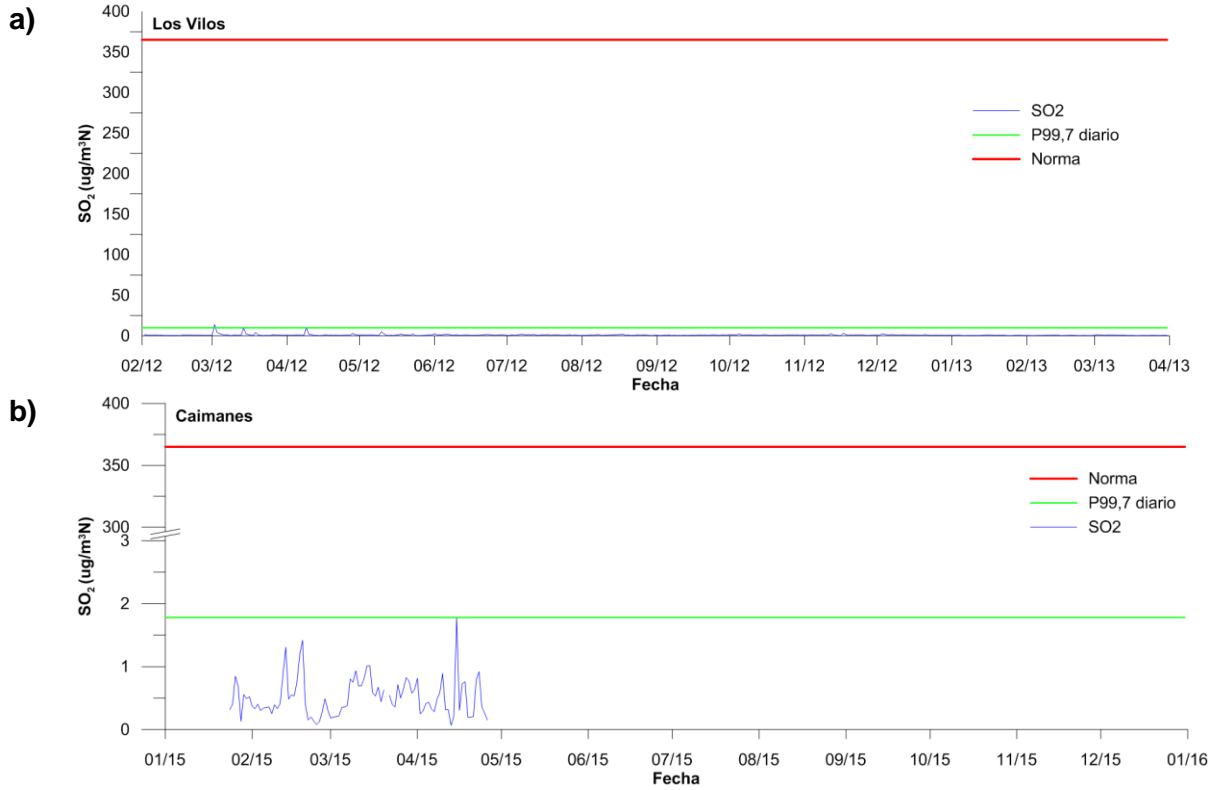
Figura CA-45: Concentración de SO 2 Percentil 99,7 diario del periodo registrado con respecto de la Norma Secundaria de SO 2 . a) Estación Los Vilos y b) Estación Caimanes
