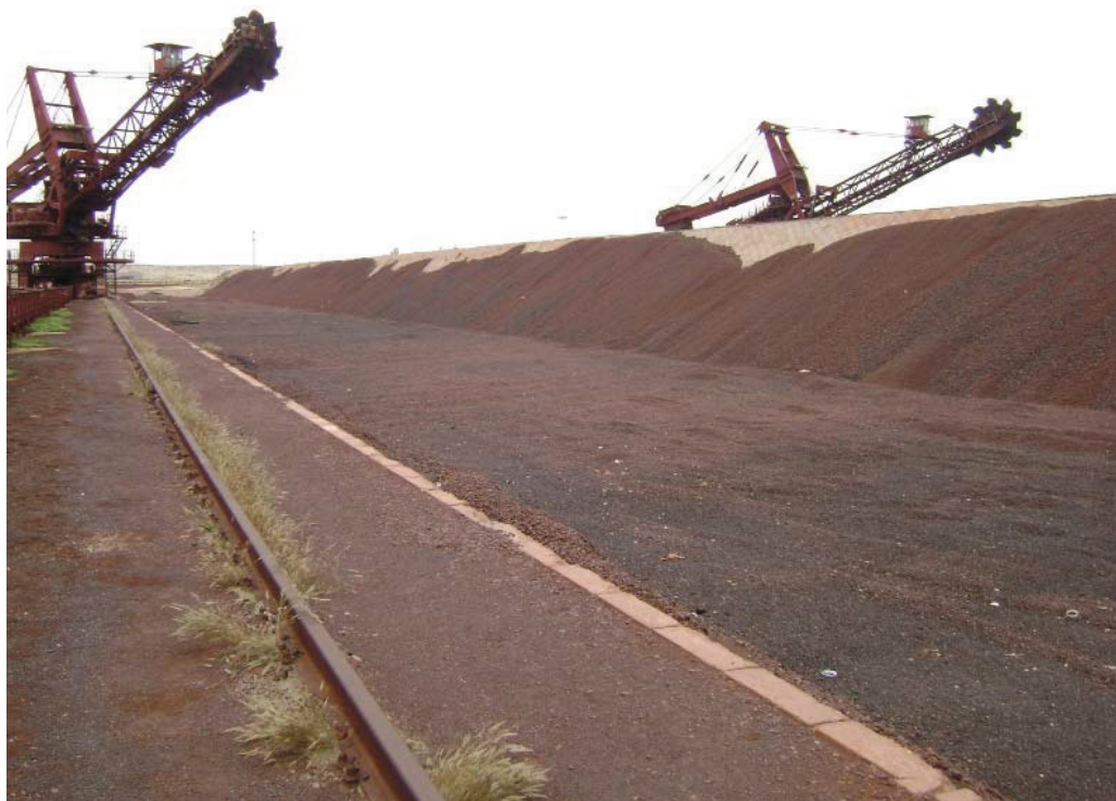
Fotografia 3.4 – Parque de armazenamento do minério de ferro, que será alvo de várias reparações. Prevê-se a utilização apenas de uma das pilhas de 500 mil toneladas
