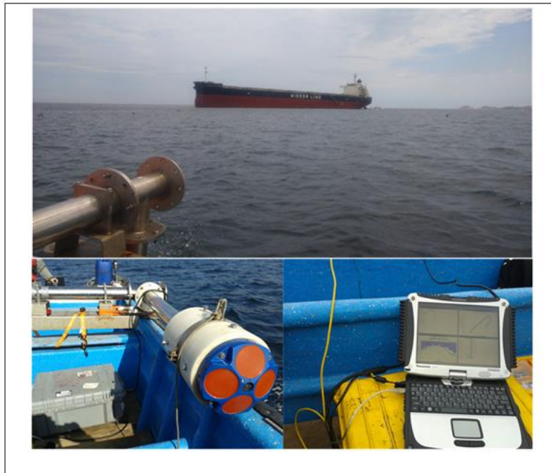
Figura 3.2.10-5. Adquisición de datos de corrientes marinas utilizando ADCP de 307,2 kHz, en tiempo real utilizando el software licenciado HYPACK y GPS diferencial marca Trimble modelo 5700.
