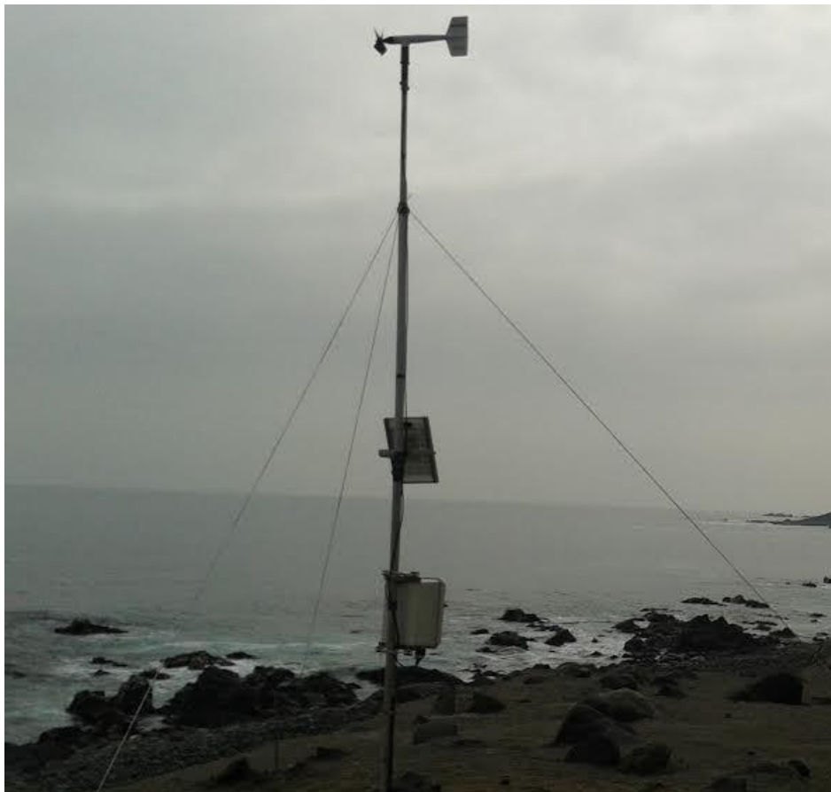
Figura 3.2.10-4. Estación meteorológica marca YOUNG, modelo 05103 Marine.
