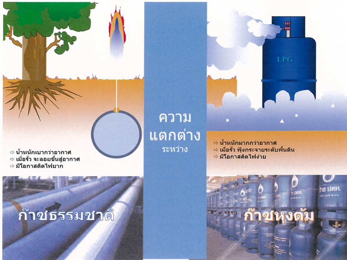
รูปที่ 5.21-7 : ตัวอย่างความแตกต่างเมื่อเกิดการรั่วไหลระหว่างก๊าซธรรมชาติและก๊าซหุงต้ม
