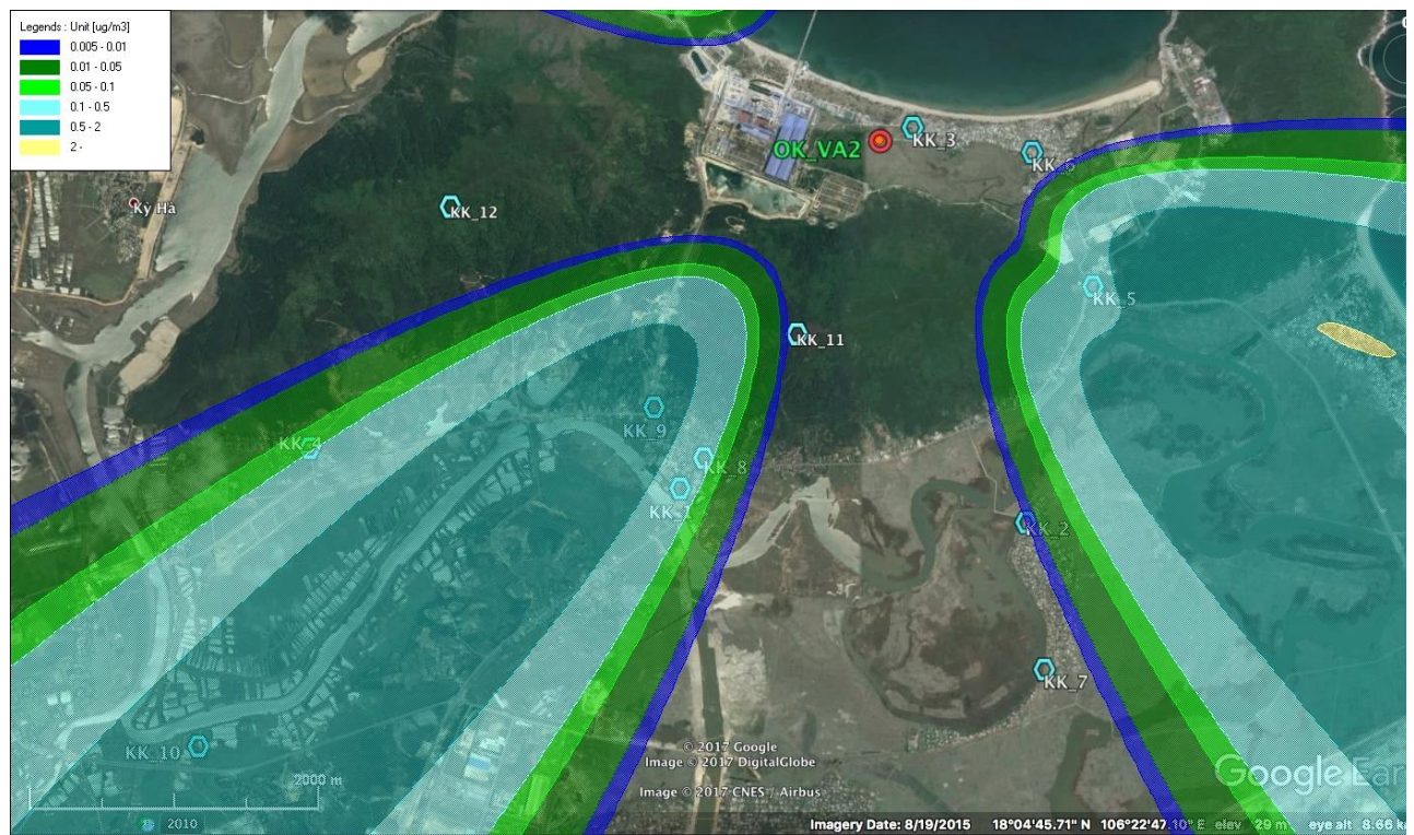
Hình 3. 6- Nồng độ bụi SO2 trung bình năm kịch bản vận hành bình thường NMNĐ Vũng Áng II
