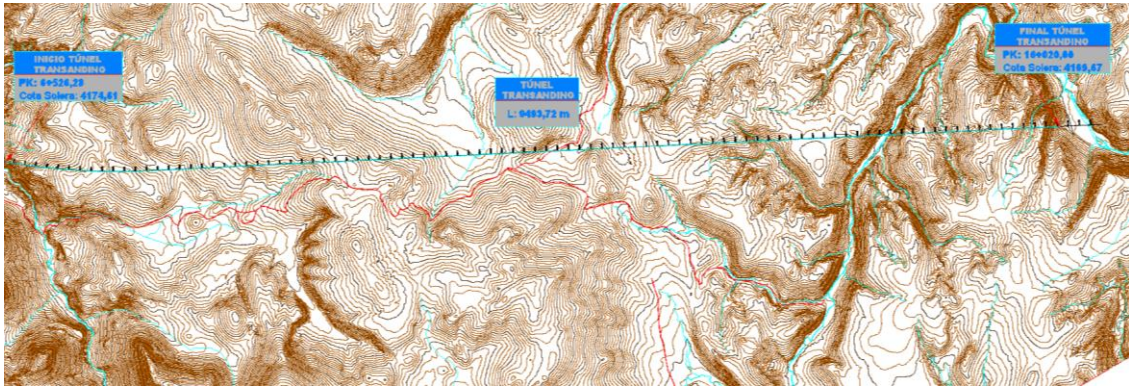
Figura 1-3 Trazado en planta túnel Transandino
