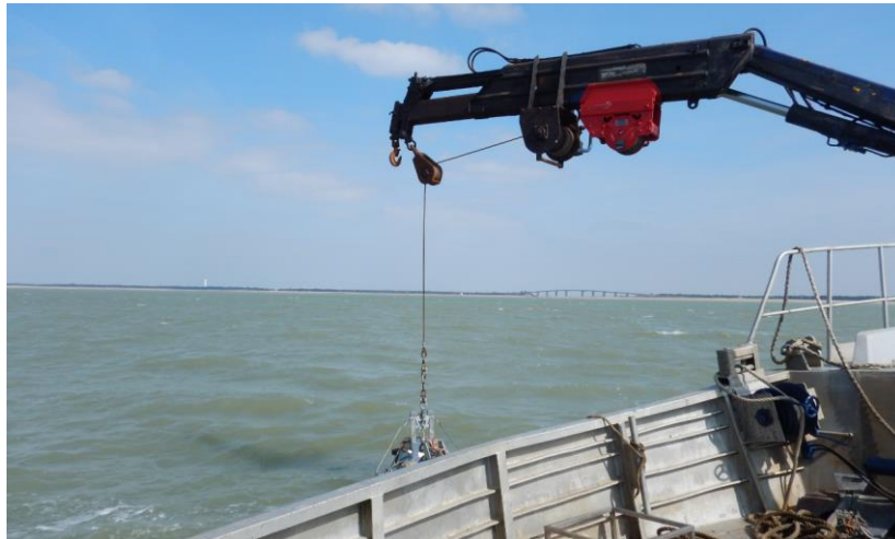
Photographie 11 : Echantillonnage à l'aide de la benne Day depuis le navire TZIGANE
