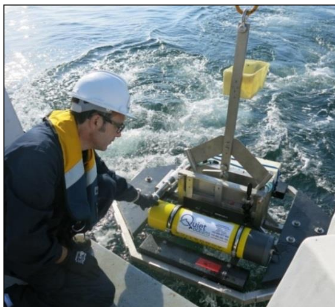
Figure 36: Déploiement d'une cage instrumentée.
