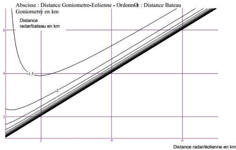
Figure 63 : Atténuation en dB du signal VHF/goniomètre en aller simple derrière un mât d'éolienne de 7m de diamètre
