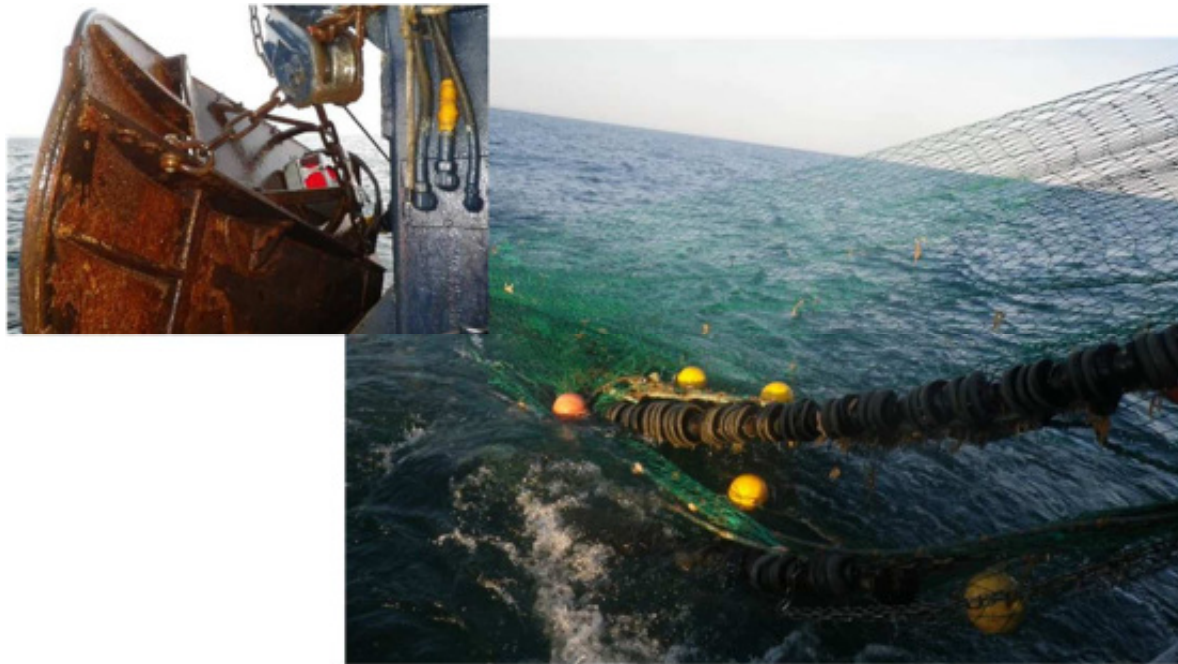
Figure 197 : Détail d'un panneau (à gauche) et d'un chalut canadien (à droite) (Source : TBM environnement)
