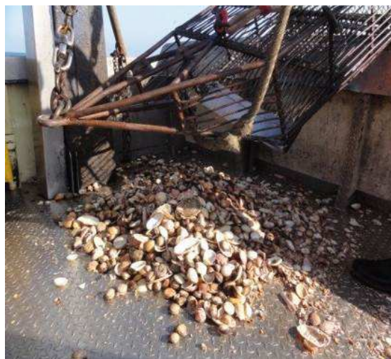
Figure 201 : Drague à amandes (Source : TBM environnement)
