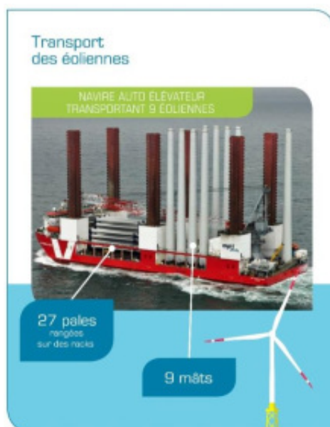
Figure 37 : Transport des éoliennes
