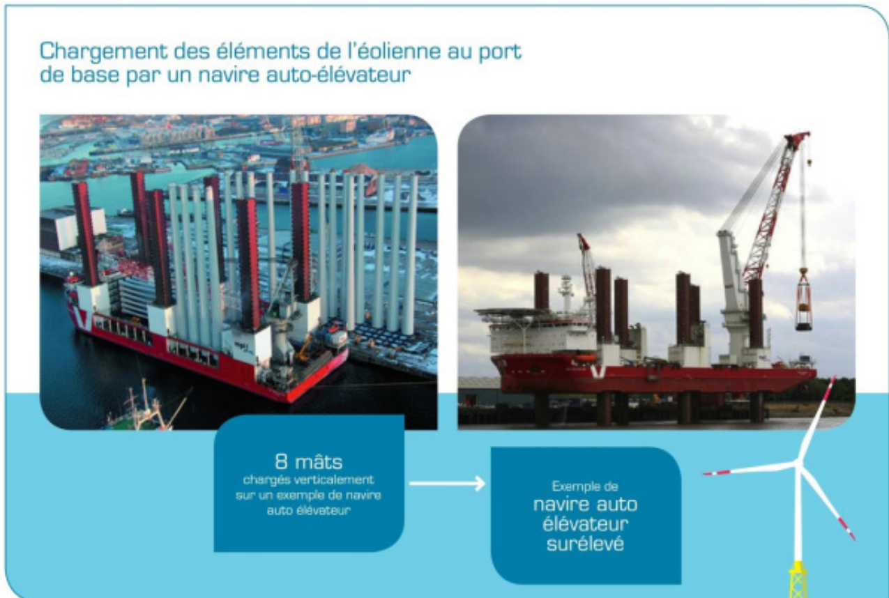
Figure 34 : Chargement des éléments de l'éolienne au port de maintenance lourde par un navire auto-élevateur
