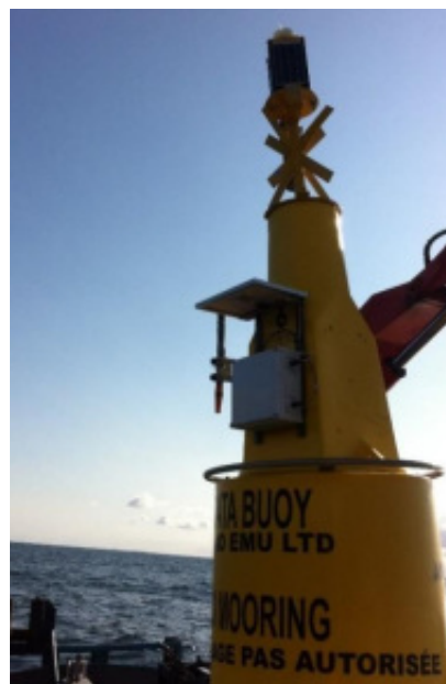
Photo 30 : Dispositif d'enregistrement mis en place sur la 1 ère bouée
