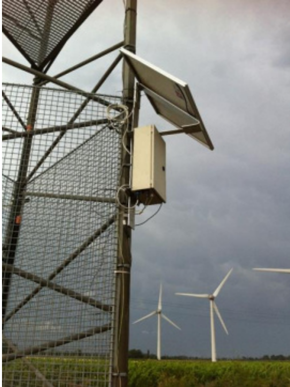
Figure 258 : Exemple de dispositif d'enregistrement acoustique avec alimentation par panneau solaire (installé sur un mât treillis)
