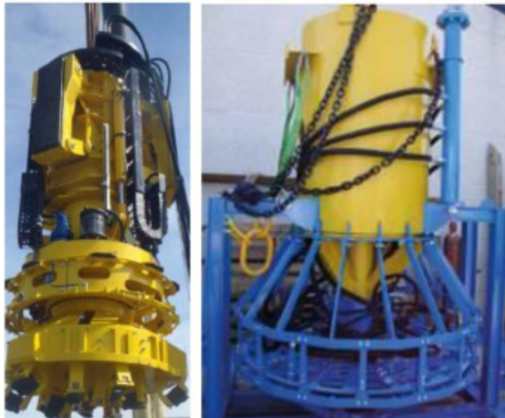
Figure 24 : Tête de forage rotative
