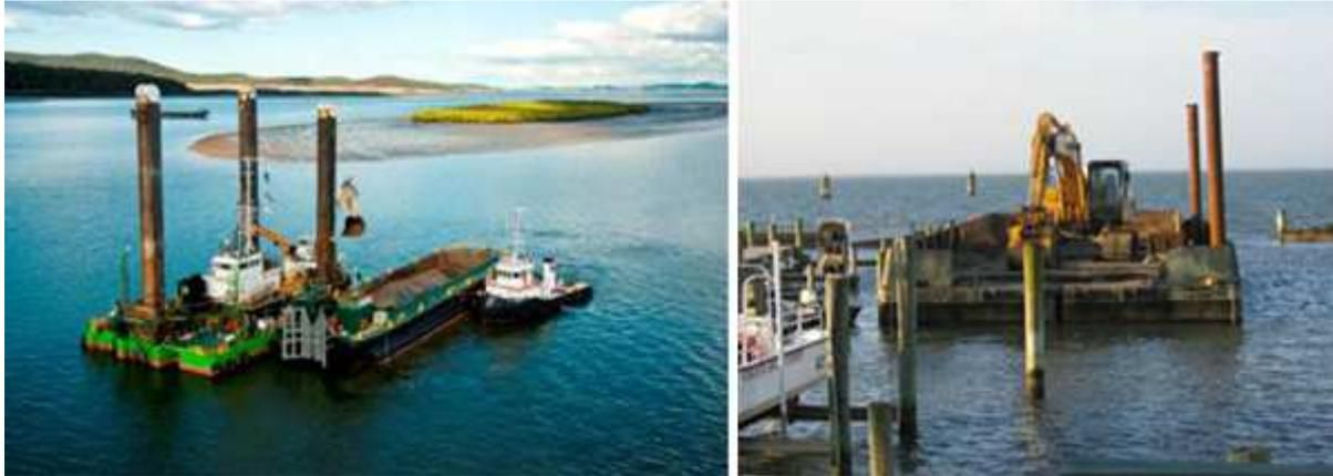
Figure 10: Pelle rétro-caveuse, ici avec navire sablier et remorqueur - Figure 11 Pelle mécanique sur barge
