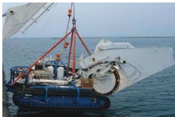
Figure 7: Exemple de trancheuse
