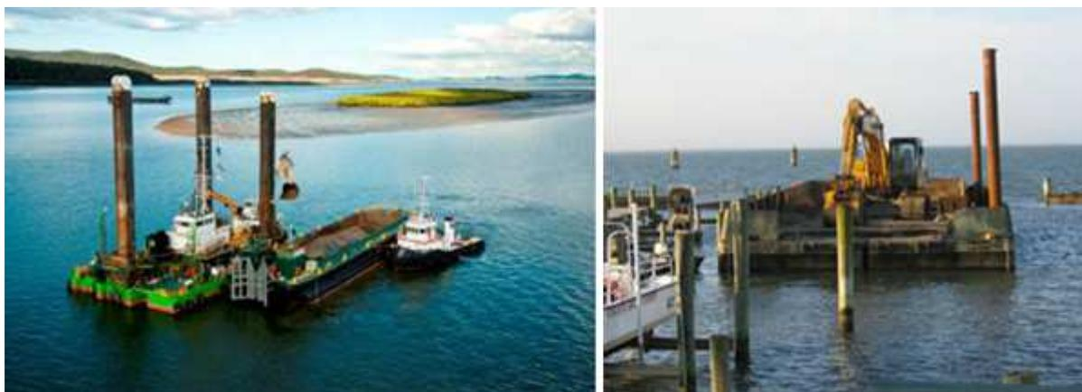
Figure 28 : Pelle rétro-caveuse, ici avec navire sablier et remorqueur - Figure 29 Pelle mécanique sur barge
