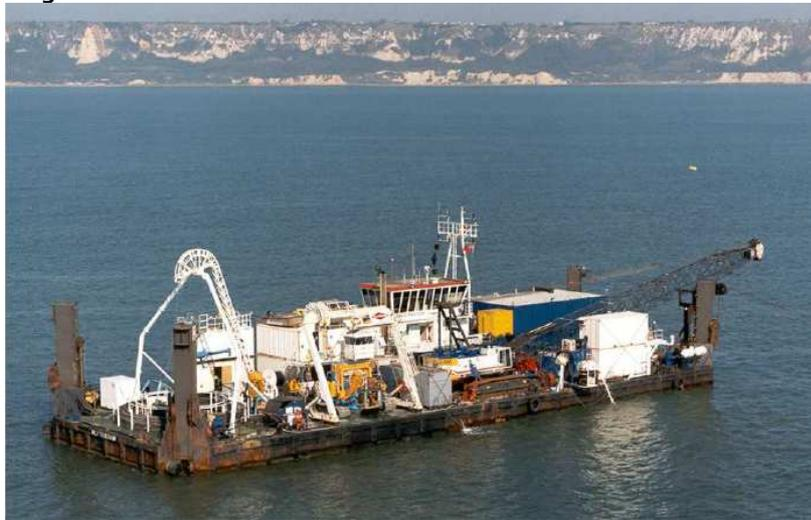
Figure 21 : Barge aménagée pour l'installation de câble en secteur côtier - Source: Stemat Marine Services
