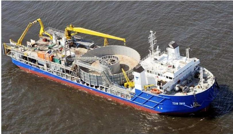
Figure 20 : Illustration d'un navire d'installation des câbles - Source : Global Marine system in RTE, 2014
