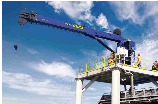
Figure 11 : Exemple de grues télescopiques inactives
