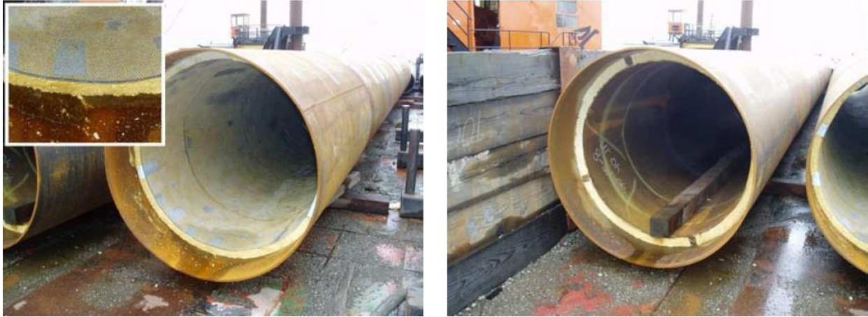
Figure 125: (a) Mousse à l'intérieur du pieu TNAP ; (b) pieu TNAP à double paroi.
