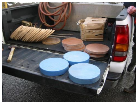
Figure 120 : Martyrs de différents matériaux utilisés lors d'opérations de battage de pieux.
