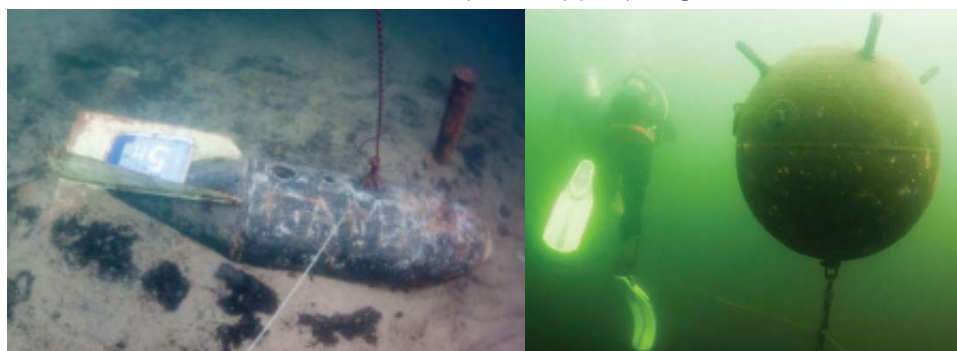
Figure 247 : Exemples d'inspections visuelles d'une bombe aérienne (à gauche) par imagerie sous-marine, et une bombe à orin (à droite) par plongée
