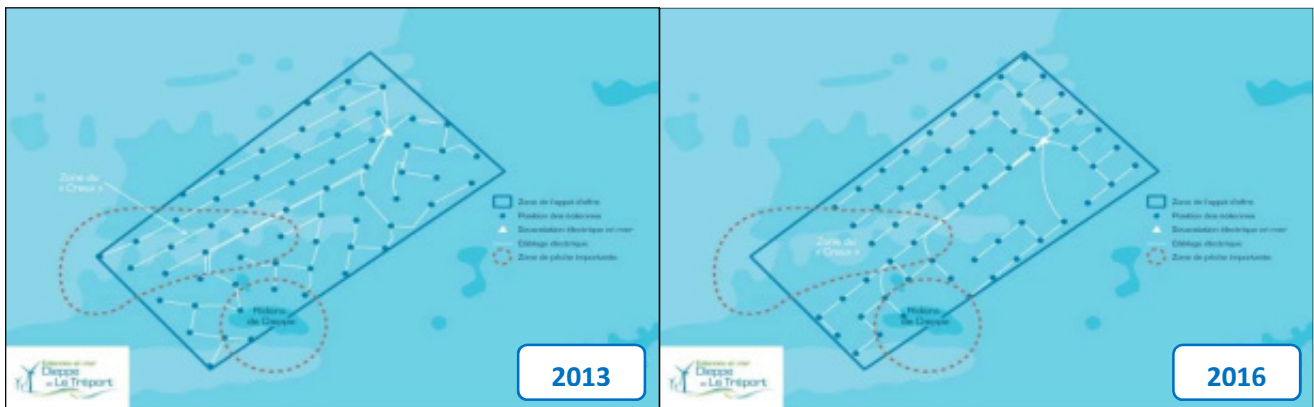
Figure 256 : Evolution du schéma d'implantation entre 2013 et 2016 pour un réduire l'impact sur la pêche
