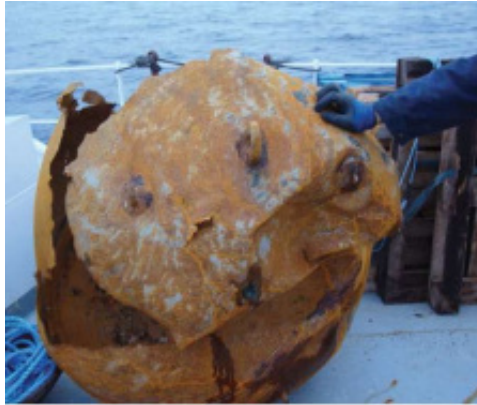
Figure 246 : Aspect général d'une mine à orin explosée sous eau
