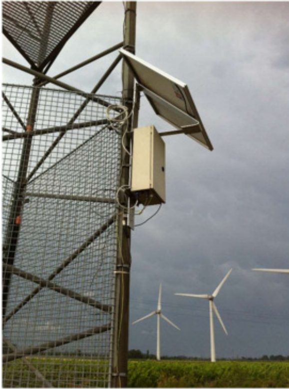
Figure 267 : Exemple de dispositif d'enregistrement acoustique avec alimentation par panneau solaire (installé sur un mât treillis)
