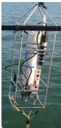
Figure 18. Sonde multi-paramètres CTD
