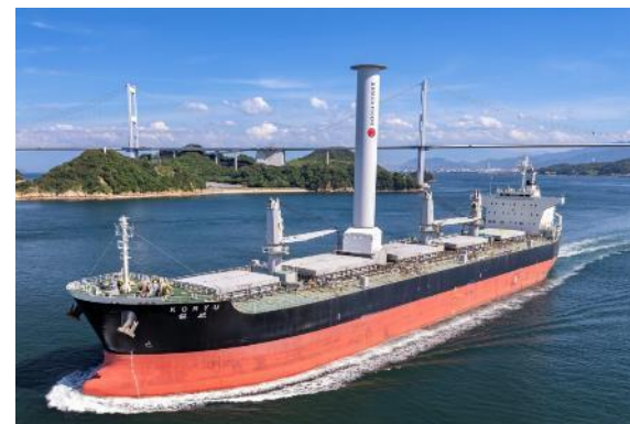
甲板上に風力推進補助装置「ローターセイル」を搭載した鉱硫船「KORYU号」 (出典: 日本マリン株式会社HP)
