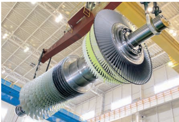
UAE シャルジャ酋長国電力・水庁向け輸出案件に用いるガスタービン
