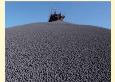
ペレットは鉄鉱石を処理して作られる直径1〜3センチ程度の大きさの粒状の製品
