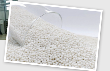
2019年に完成したマレーシア第3工場。ここでは主に、使用済みペットボトルから食品向けリサイクルPET樹脂(右)を製造している
