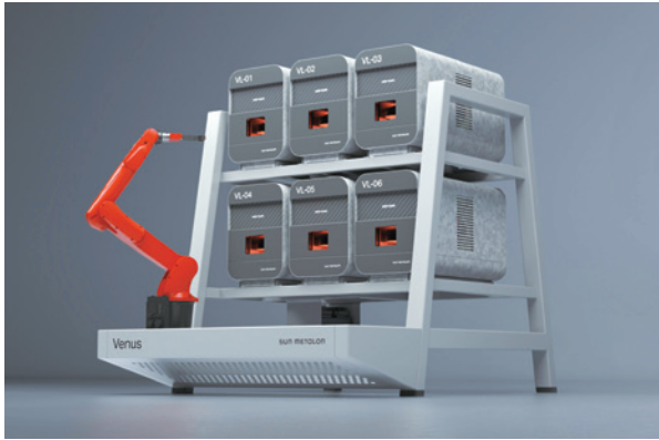
低コスト、低CO 2 排出、省スペースを特徴とする金属リサイクル装置Venus (提供：Sun Metalon)
